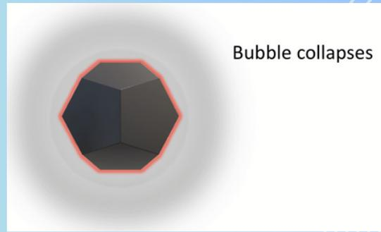
几纳秒后，气泡膨胀停止，并向墨水颗粒方向塌陷。这会将一些潜热能返回到颗粒表面，然后重新加热，从凝结的液滴中产生更多的蒸汽泡。
